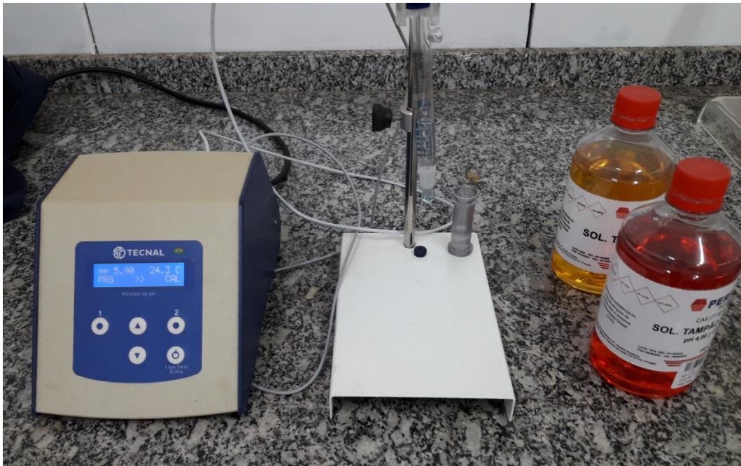
Figura 6: pHmetro e soluções tampões de pH 4 e 7
