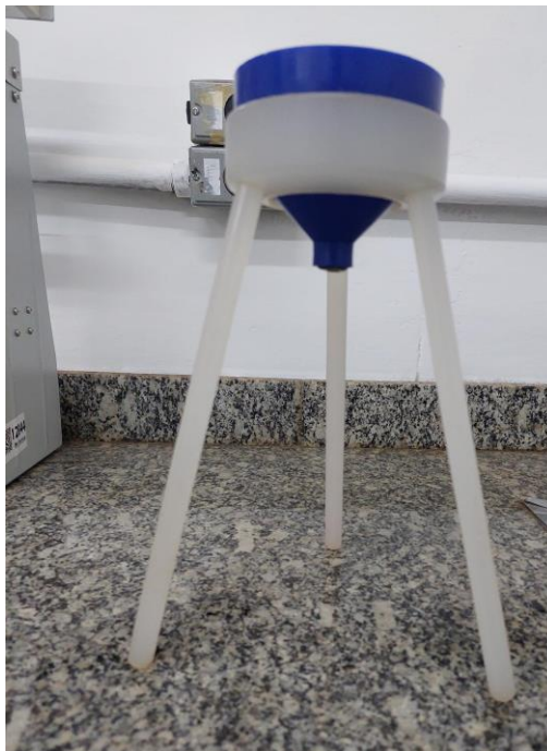
Figura 20: Viscosímetro tipo Copo Ford de plástico orifício em latão calibrado (Autor).
