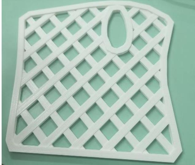
**Figura 17:** Órtese final feita na impressora 3D.
