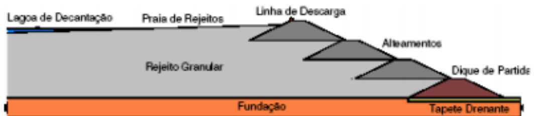
Figura 6: Alçamento de montante.
