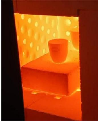
**Figura 17:** Cadinhos no interior de forno, após homogeneização a altas temperaturas.
