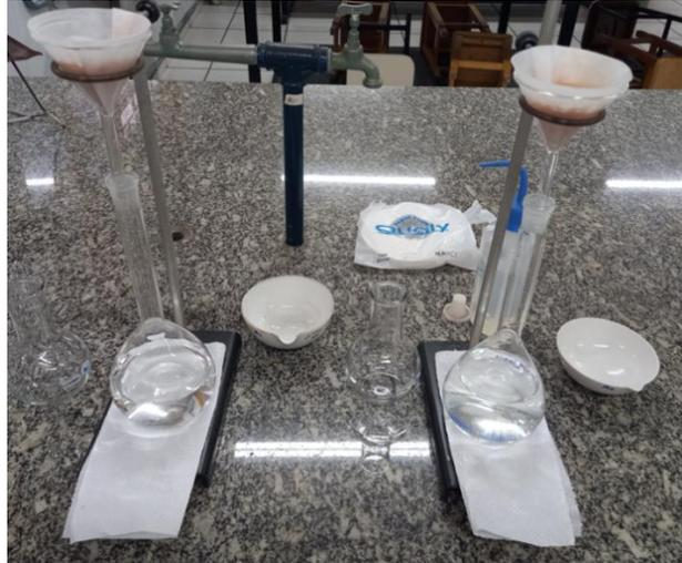
**Figura 16:** Filtração dos sólidos obtidos, após realização de digestão ácida.
