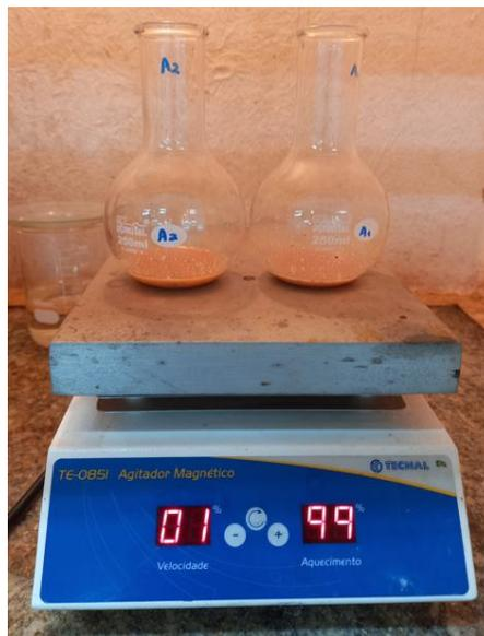
**Figura 15:** Realização de digestão ácida das amostras em chapa aquecedora, no interior de capela de exaustão.
