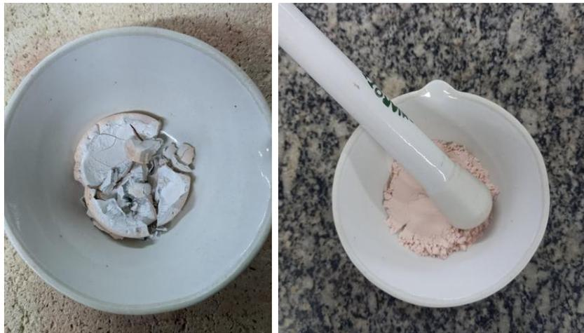
**Figura 14:** Amostra sólida obtida, após realização de tratamento térmico em forno mufla.
