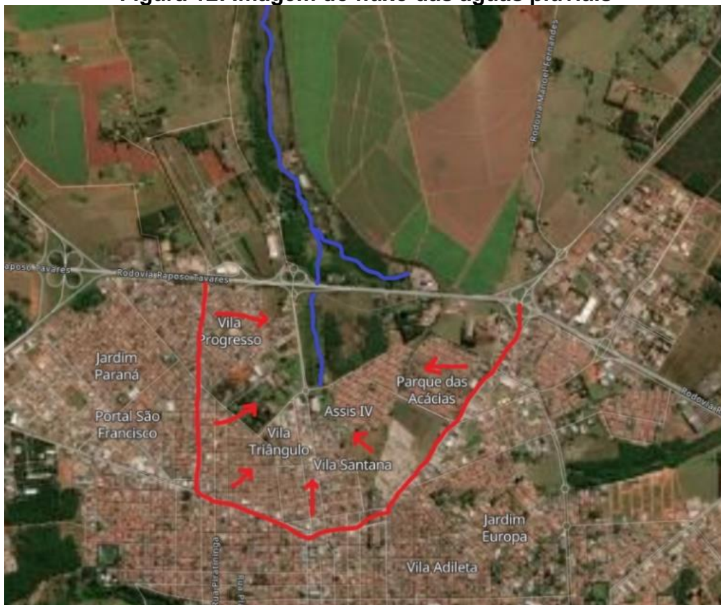
Figura 12: Imagem do fluxo das águas pluviais
