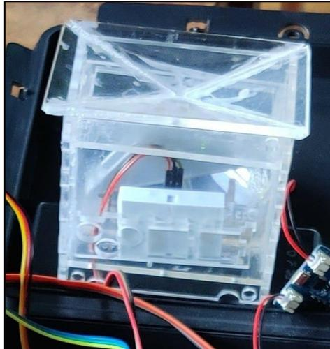
**Figura 30:** Pluviômetro de balança digital.
