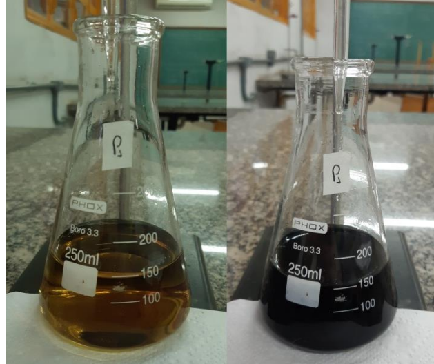
Figura 11: Titulação com o tiosulfato de sódio e mais 2 mL da solução de amido 1%
