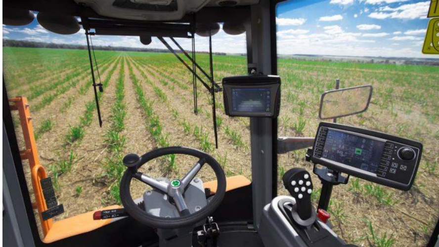
Figura 3: Piloto automático no interior do implemento.
