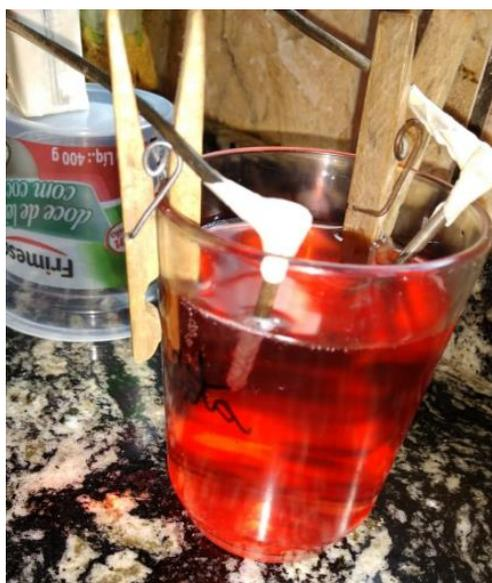
**Figura 12.** Formação de bolhas de Hidrogênio no cátodo e liberação de íons metálicos no ânodo.
