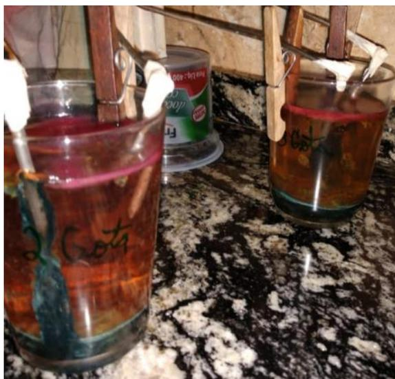
**Figura 13.** Diminuição na quantidade de hidrogênio na região catódica e sedimentação de íons metálicos e impurezas (corantes) na região anódica e no fundo.
