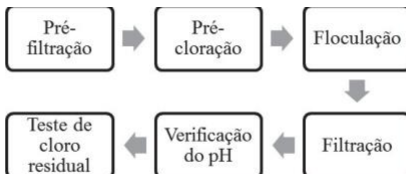
Figura 2: Ordem de tratamento da água (FOLEIS et al., 2015, p.71).
