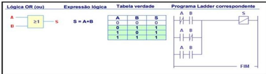
Figura 13 - Porta Lógica OR com o diagrama Ladder correspondente
