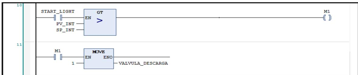
**Figura 24** - Acionamento Válvula de Descarga
