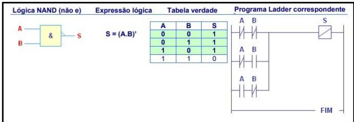
Figura 15 - Porta Lógica NAND com o diagrama Ladder correspondente
