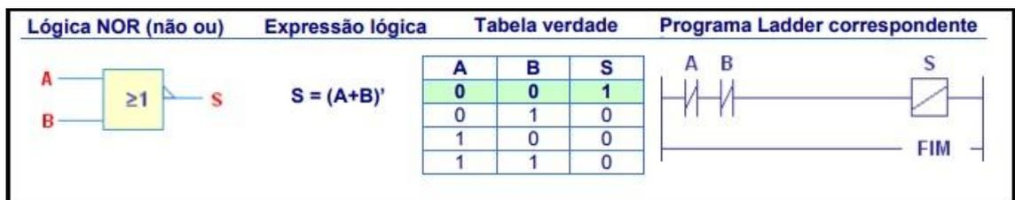
Figura 16 - Porta Lógica NOR com o diagrama Ladder correspondente
