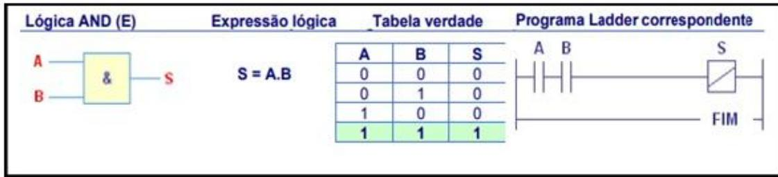
Figura 12 - Porta Lógica AND com o diagrama Ladder correspondente
