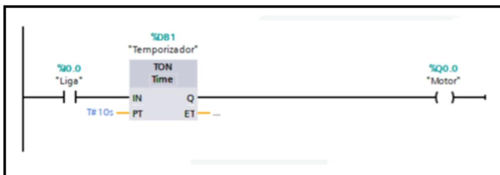
**Figura 5** Aplicação do temporizador TON
