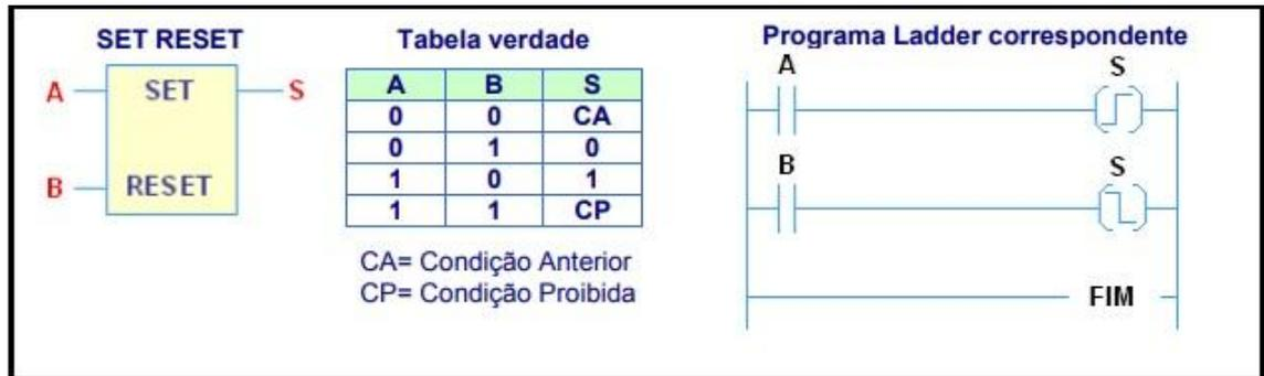
Figura 18 - Porta Lógica SET RESET com o diagrama Ladder correspondente
