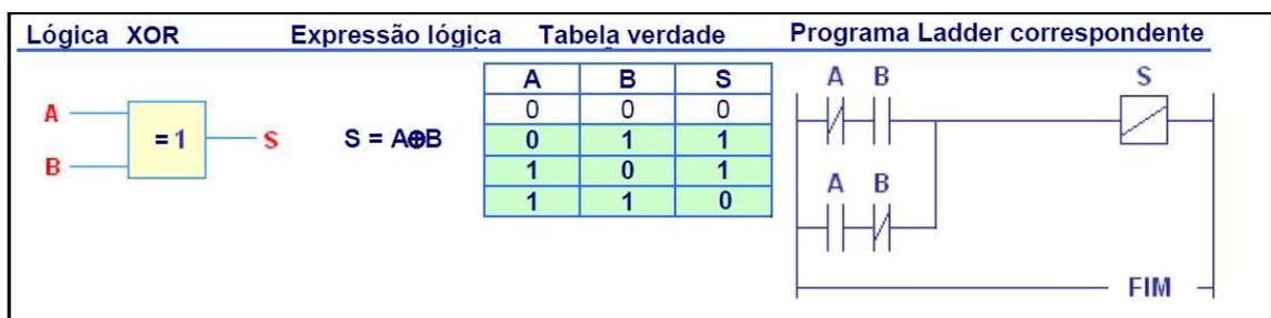
Figura 17 - Porta Lógica XOR com o diagrama Ladder correspondente
