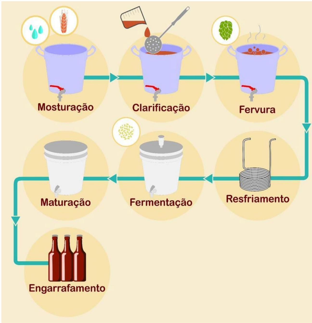
**Figura 2:** Fluxograma simplificado do processo de fabricação da cerveja (In DIAS, 2020)
