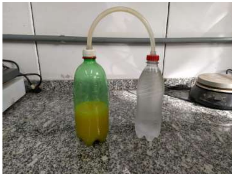
Figura 7: Transferência da água gaseificada para o pré-mix
