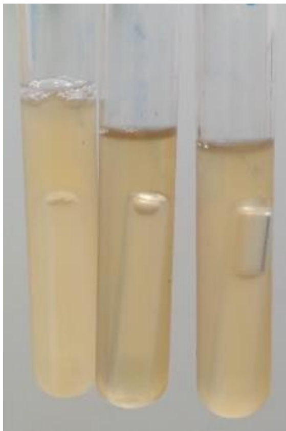
Figura 16: Tubos com CLS indicando presença de coliformes
