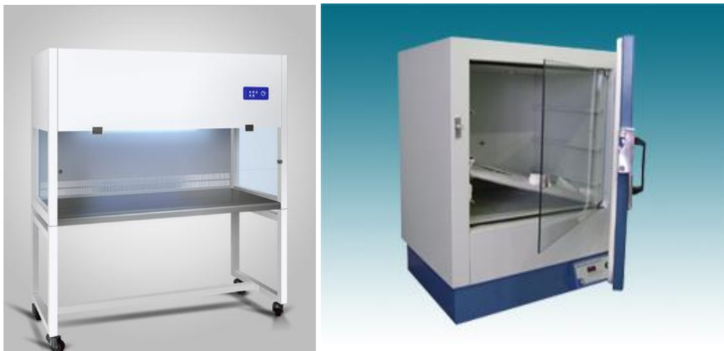
Figura 8: Câmara de fluxo laminar e estufa para incubação microbiológica.
