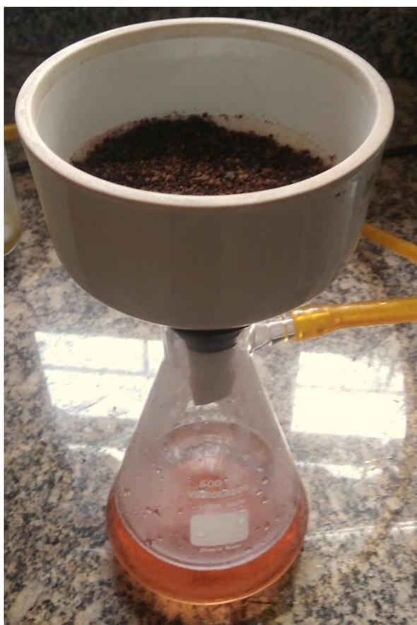
**Figura 8:** Filtração a vácuo do extrato.
