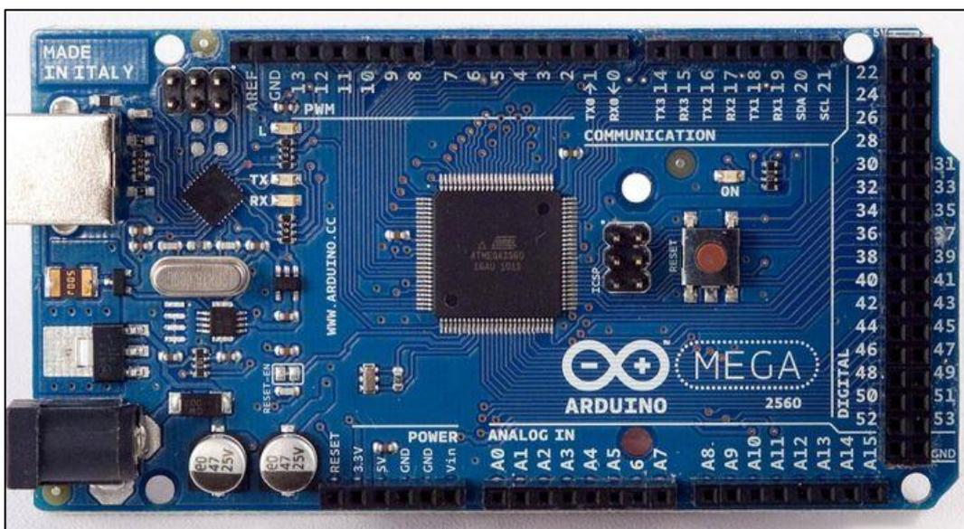
**Figura 7 - Arduino Mega 2560**
