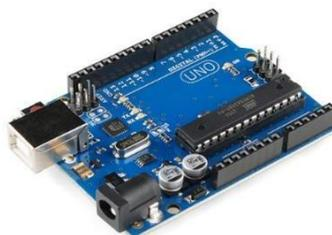
Figura 5 – Arduino Uno. Fonte: ([www.filipeflop.com/produto/placa-uno-r3-cabo-usb-para-arduino/](http://www.filipeflop.com/produto/placa-uno-r3-cabo-usb-para-arduino/))
