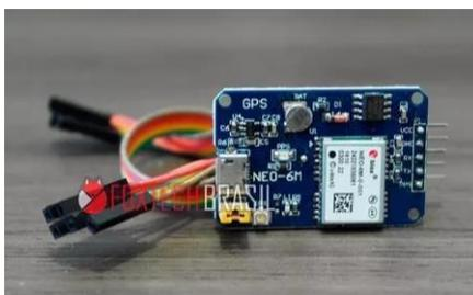
Figura 7 – Módulo GPS Neo-6m. Fonte: ([https://produto.mercadolivre.com.br/MLB-948086838-modulo-gps-neo-6m-arduino-drone-antena-onboard-micro-usb-\\_JM](https://produto.mercadolivre.com.br/MLB-948086838-modulo-gps-neo-6m-arduino-drone-antena-onboard-micro-usb-_JM))
