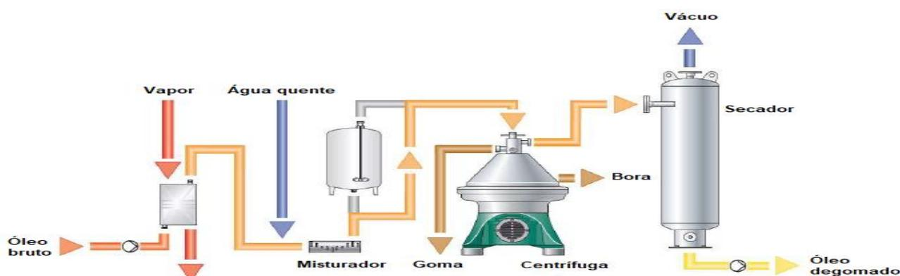
**Figura 6:** Equipamento de degomagem com água (GONDIN, 2019).
