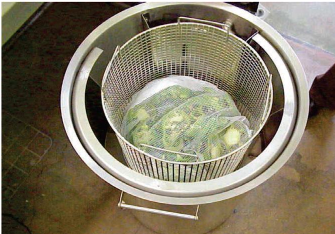
Figura 10 – Centrifuga industrial utilizada no processamento mínimo de hortaliças. (In: MORETTI, 2007).
