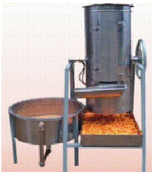
Figura 8 – Torneadora múltipla (In: SILVA et al., 2000).
