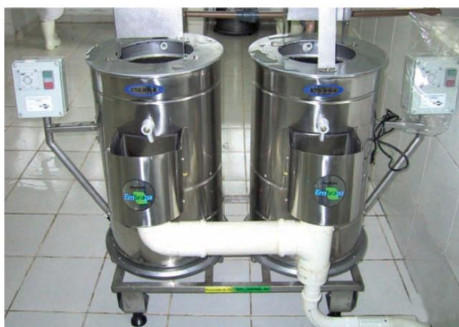
Figura 9 – Outra torneadora múltipla, equipamento desenvolvido para processar minicenouras, batata e beterraba (In: SILVA et al., 2000).
