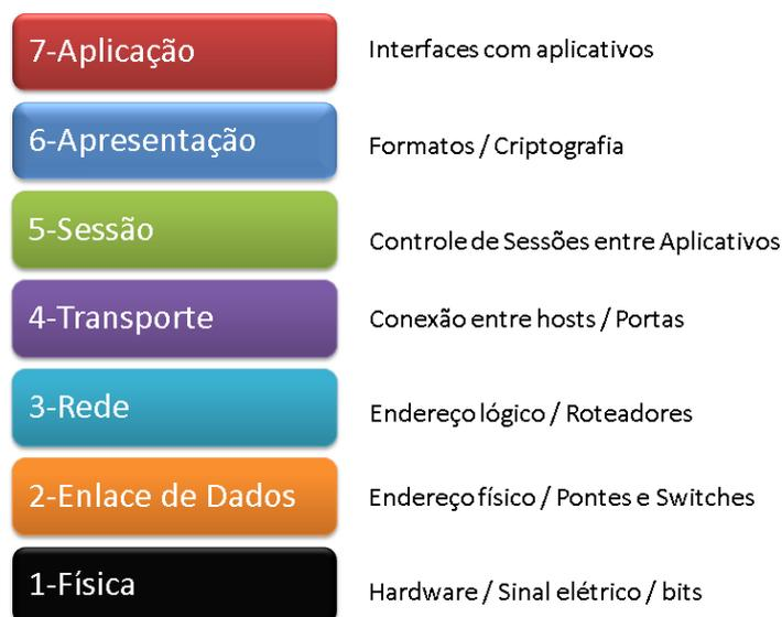
**Figura 1:** Camadas do Modelo OSI (In: KOLB, 2016)
