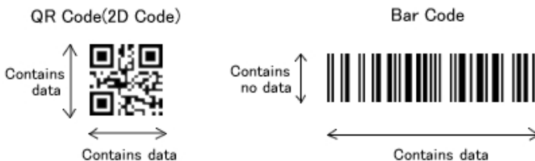
Figura 8: QR code comparado com um código de barras normal
