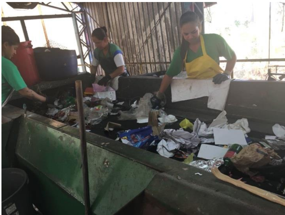
Figura 9: Esteira de Separação de Materiais
