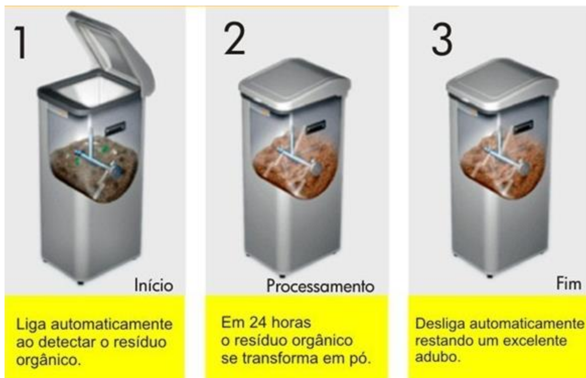
Figura 19: Funcionamento composteira elétrica (ecoisas.com.br)
