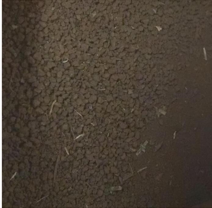
**Figura 6:** Solo moído na espessura menor que 2 milímetros, pronto para as análises.
