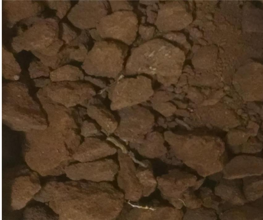
**Figura 5:** Solo coletado com trado de rosca, preparada para a moagem.
