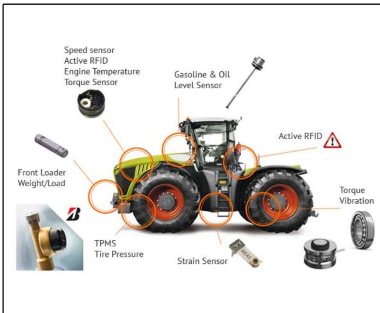
Figura 1 - Sensores IoT aplicados em máquinas agrícolas (In: STECON, 2017)
