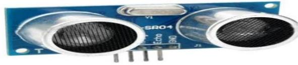
**Figura 15- Sensor de Distância Ultrasônico HCR04**
