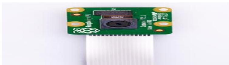
**Figura 13- RaspBerry Pi Camera**
