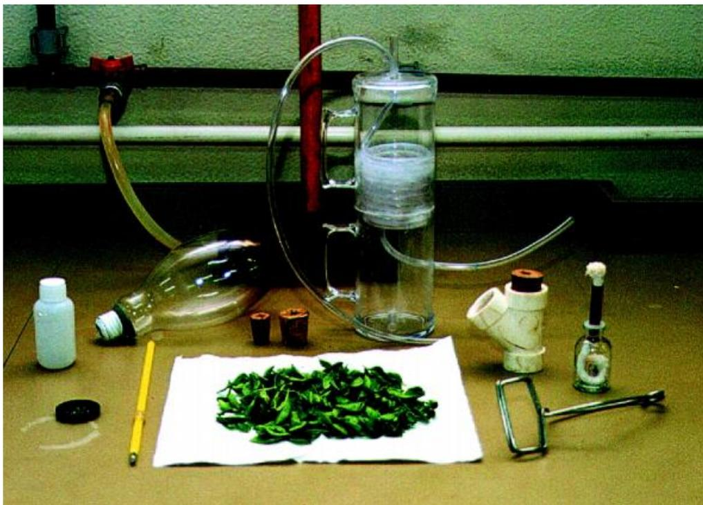
**Figura 10:** Sistema de destilação por arraste a vapor.
