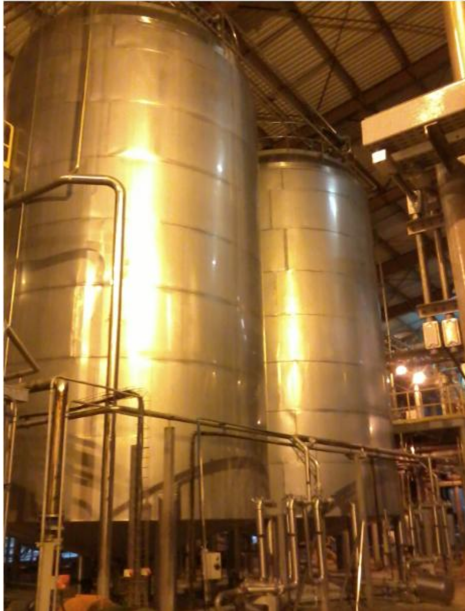
Figura 1: Tanque de aço inox utilizado para reprodução de levedura (In: Acervo pessoal, imagem empresa Zilor – Quatá/SP).
