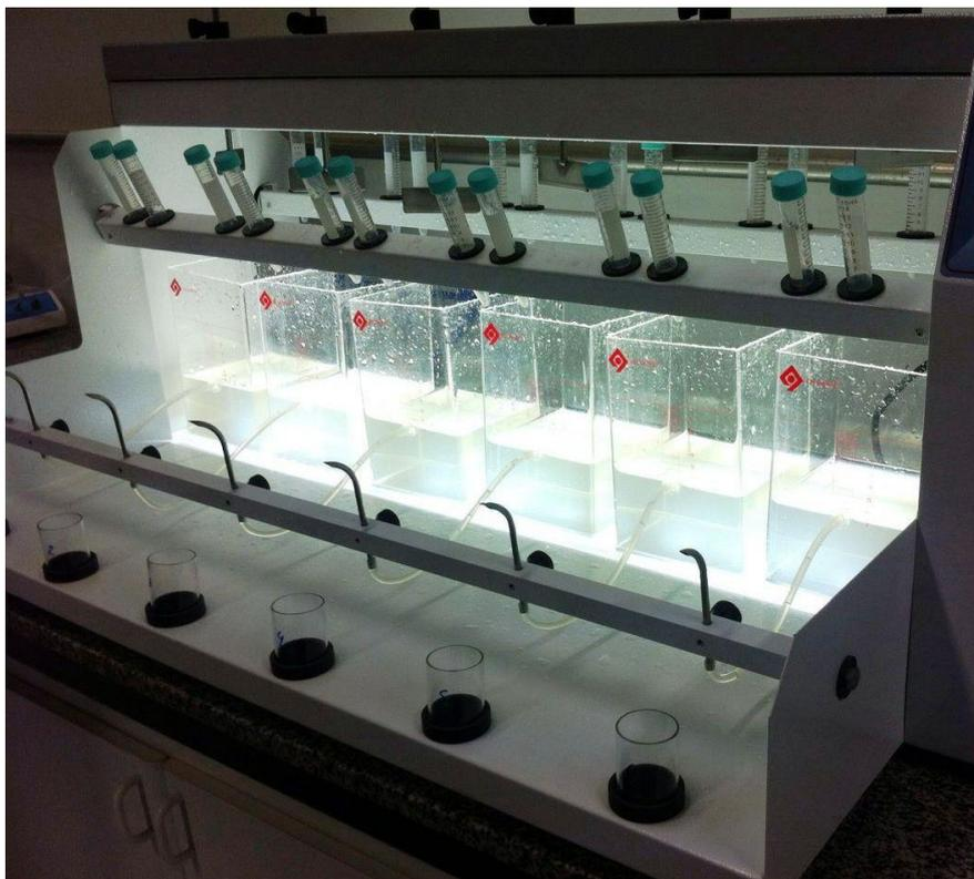
**Figura 4:** Equipamento Jar-test de realização de testes de jarros.
