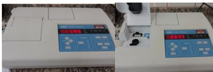
**Figura 4:** Aparelho para medição de turbidez da água (Marca: HACH, modelo: 2100N).
