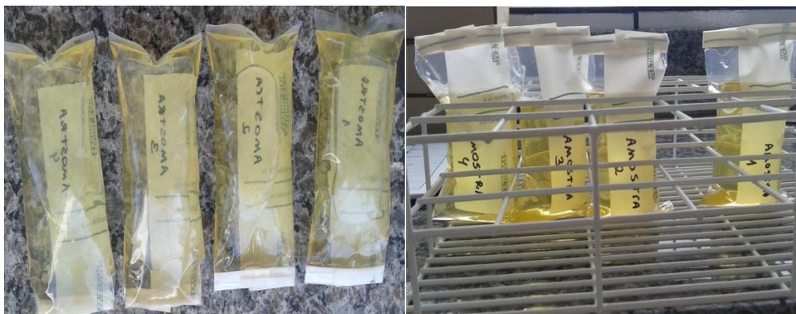
**Figura 18-** Determinação de Coliformes Totais e *E. Coli* pelo método colitag.
