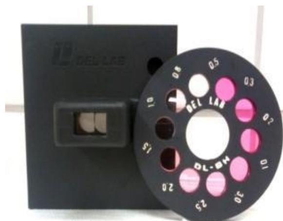
**Figura 7-** Aparelho colorímetro e disco de cores (Marca: Del Lab; modelo: DL-BH).
