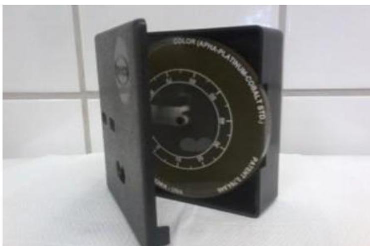
**Figura 3:** Disco de cores acoplado ao aparelho colorímetro.
