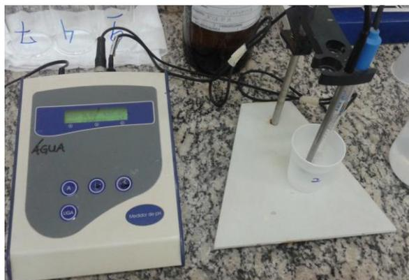
**Figura 5:** Aparelho pHmetro (Marca: TecnoPON, modelo: mPA 210)
