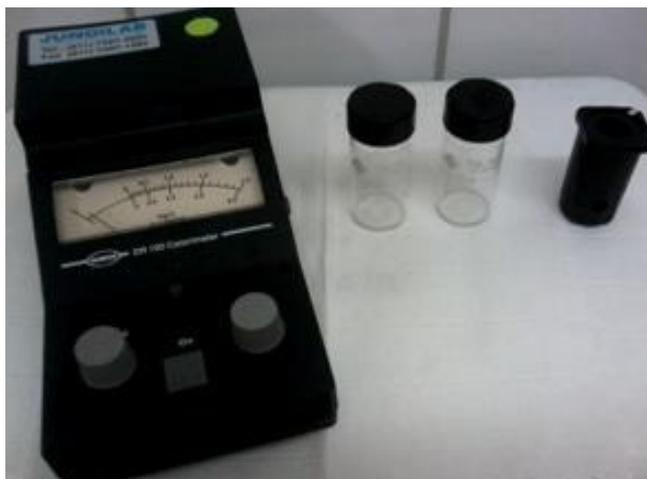
**Figura 6:** Aparelho fluorímetro, cubeta e adaptador.
