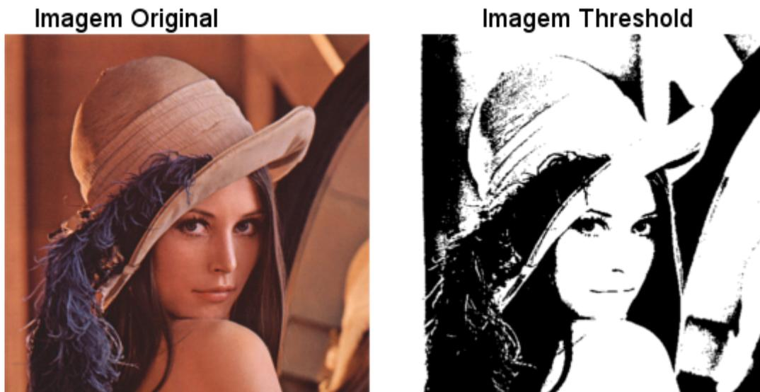
Figura 19: Efeito do filtro *threshold*
