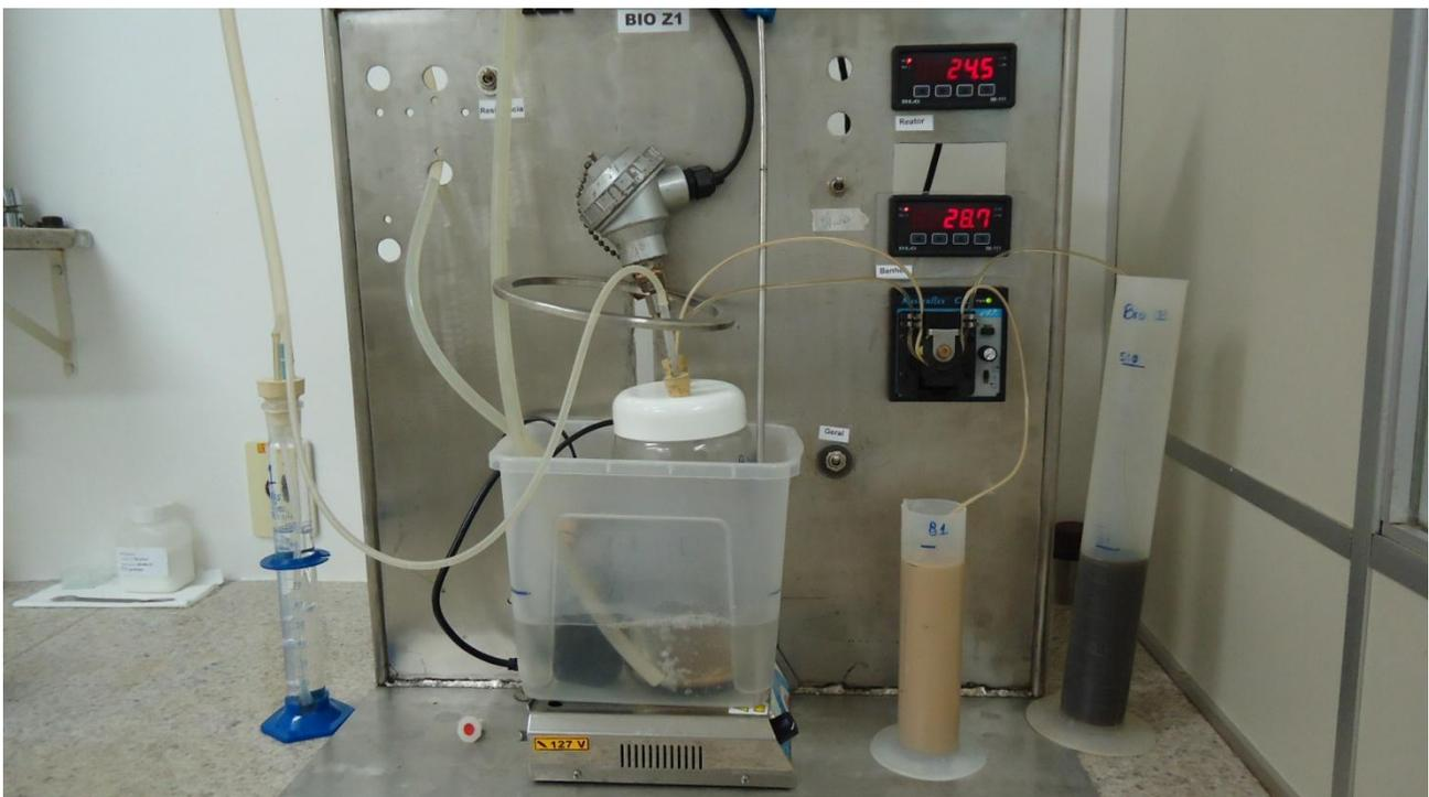
**Figura 9:** Biorreator sendo alimentado.
