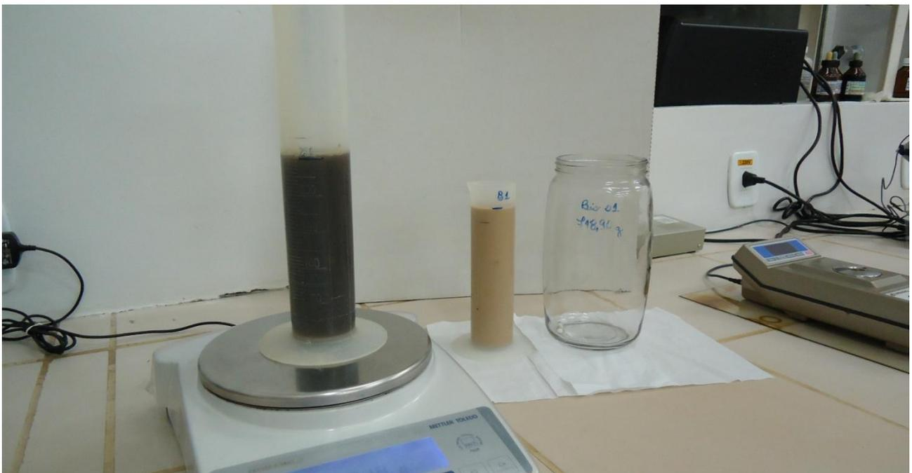
**Figura 8:** Pesagem das amostras e do corpo do reator.
