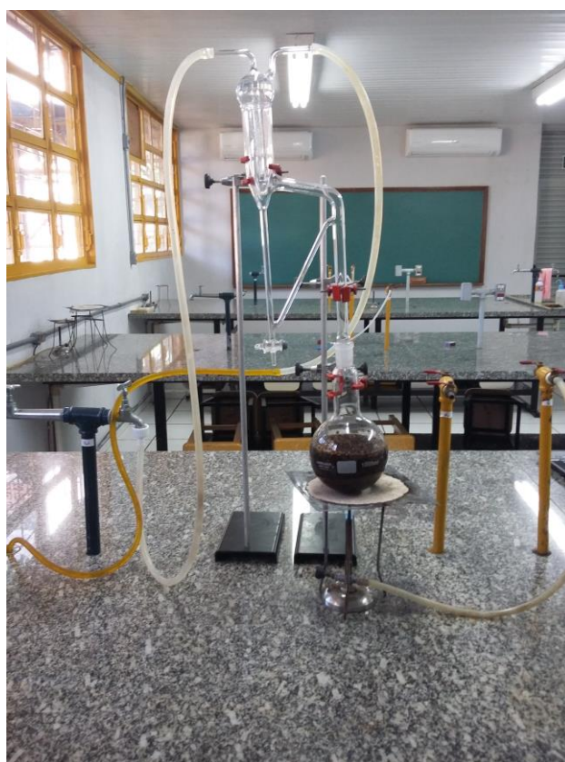
Figura 15 - Sistema extrator de Clevenger acoplado a um balão de fundo redondo de 1000 mL.
