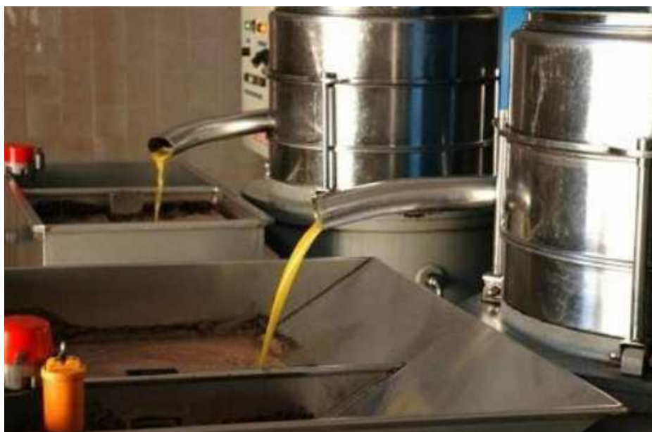
Figura 10 – Processo de extração por prensagem (In: SILVEIRA et al., 2012, p. 2049).
