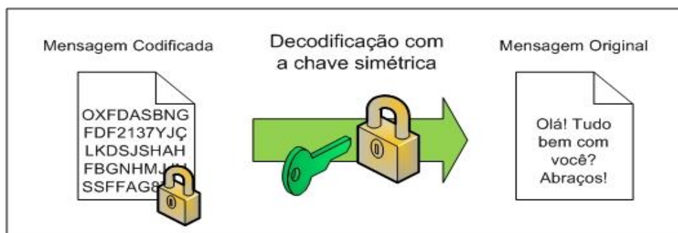
Figura 10 – Criptografia: Decodificação usando chave simétrica. Fonte livro “Computer Networks - Vol: 4” (2003).
