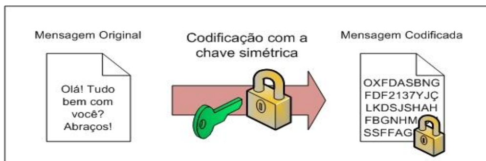
Figura 9 – Criptografia: Codificação usando chave simétrica. Fonte livro “Computer Networks - Vol: 4” (2003).
