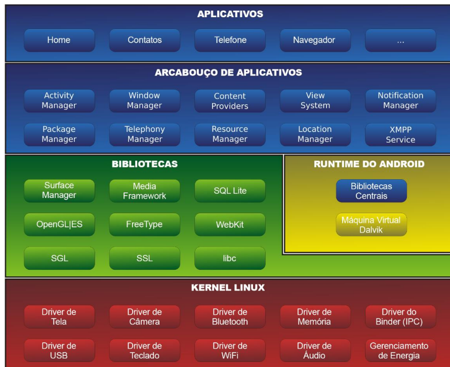
Figura 3 Diagrama das Camadas da Plataforma Android
