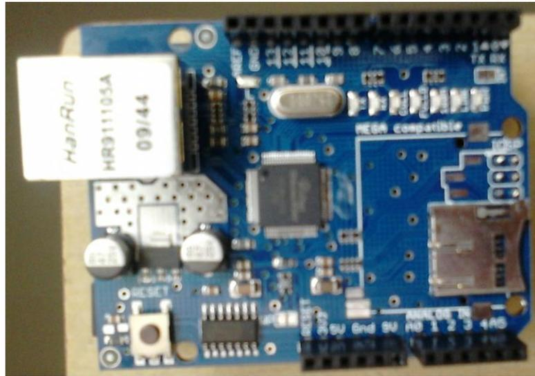
**Figura 6 - Placa Ethernet Shield**
