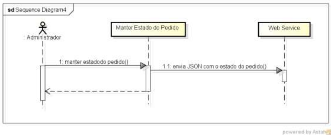
Figura 26: Diagrama de Sequência do Web Site em C# - Manter Pedido
