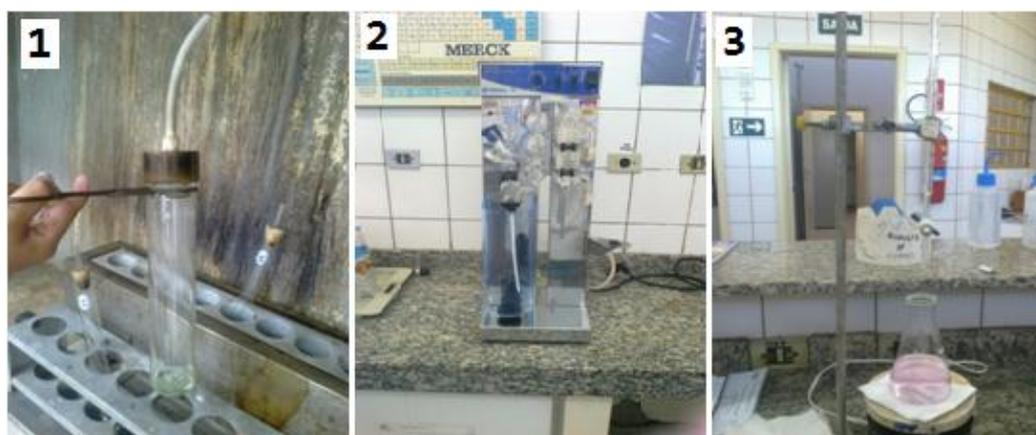
**Figura 10: Imagens da análise de proteína pelo método de Kjeldhal (1: digestão ácida; 2: destilação do sulfato de amônio; 3 titulação do borato de amônio com ácido clorídrico)**
