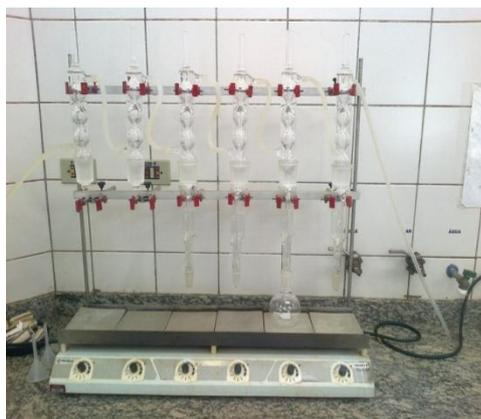
**Figura 12: Aparelho de Soxhlet utilizado para determinação do extrato etéreo.**
