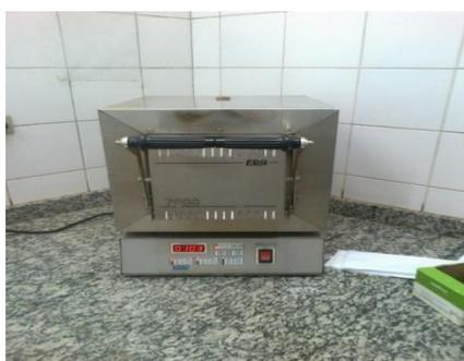
**Figura 11: Mufla Utilizada para Análise de Cinzas**
