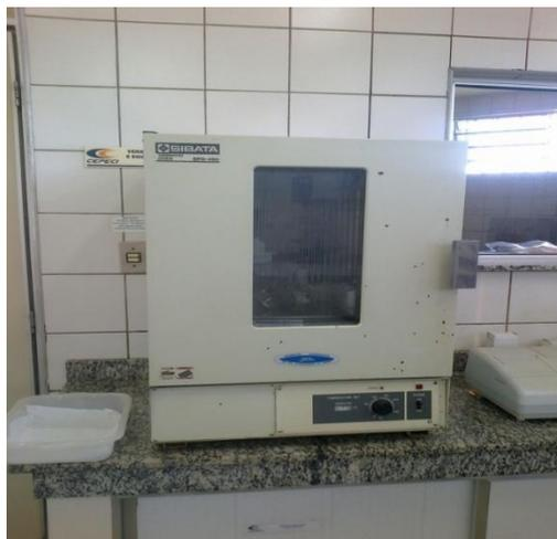
**Figura 9: Estufa de secagem, regulada à 105°C utilizada para análise de umidade.**
