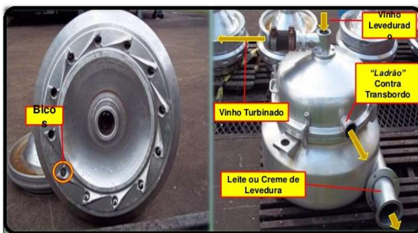
Figura 19: Demonstra a centrífuga de fermento (In: www.alvoradabebedouro.com.br ).
