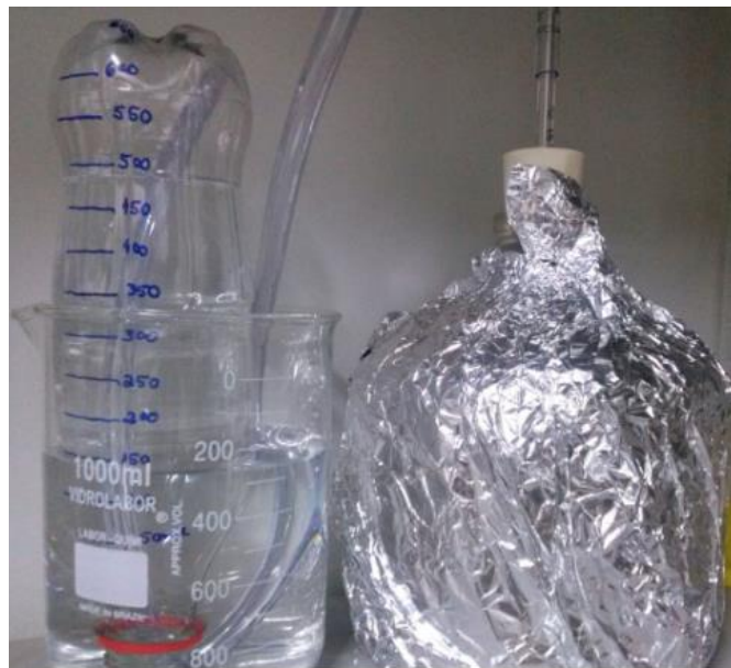
Figura 6: Modelo do biodigestor.
