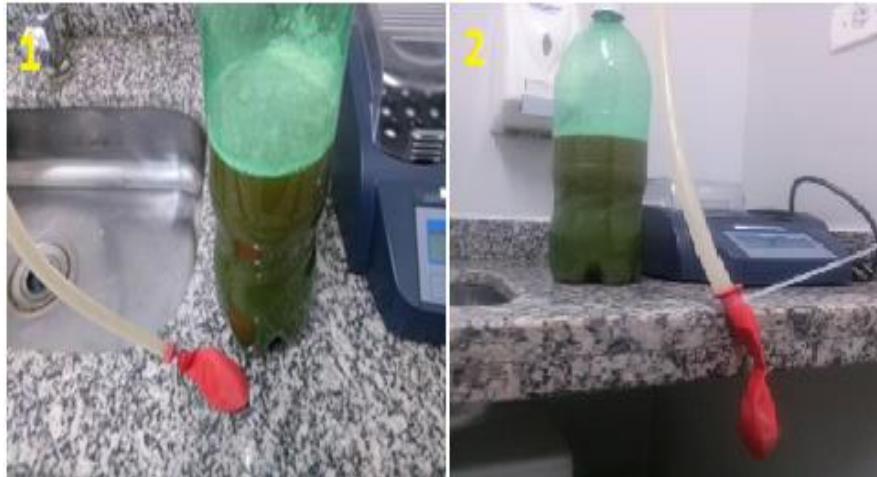
Figura 15: Ilustração do primeiro (1) ao vigésimo primeiro dia (2), no segundo experimento de biodigestão da vinhaça.
