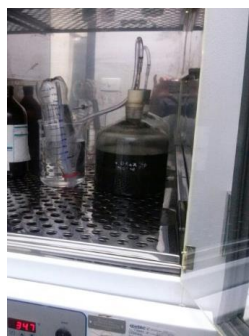
Figura 18: Biodigestor armazenado à 35,0°C em estufa.
