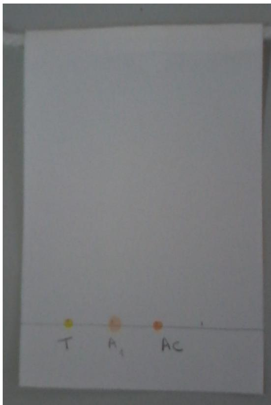
**Figura 23 – Cromatograma de identificação dos corante orgânicos artificiais de amostras de refrigerante sabor laranja**
