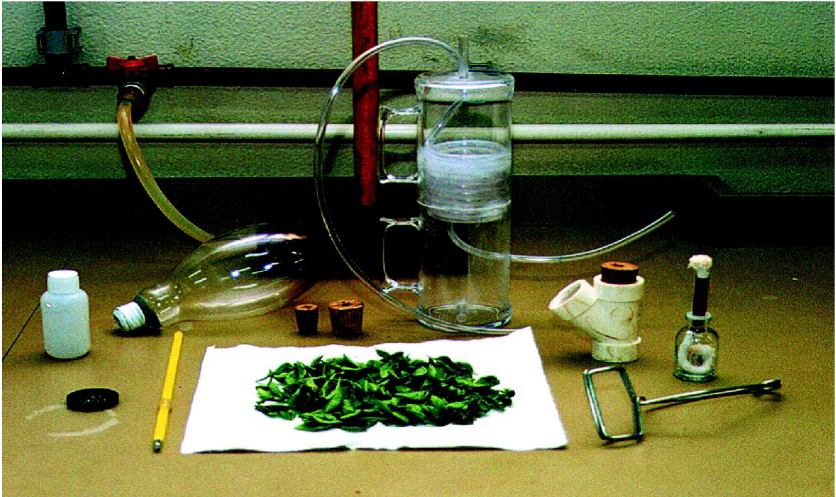
A Figura 17- Material de fácil obtenção para confecção de aparelho de destilação por arraste a vapor ( In: GUIMARÃES, OLIVEIRA, ABREU, 2000, p.45)
