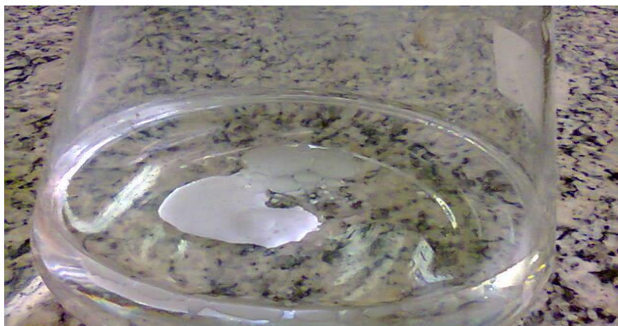
Figura 22- Emulsão desfeita com adição de sulfato de sódio anidro.
