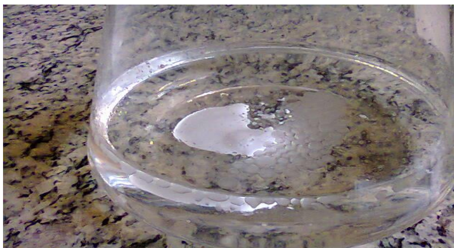
Figura 21- Emulsão sendo desfeita pela adição de sulfato de sódio anidro
