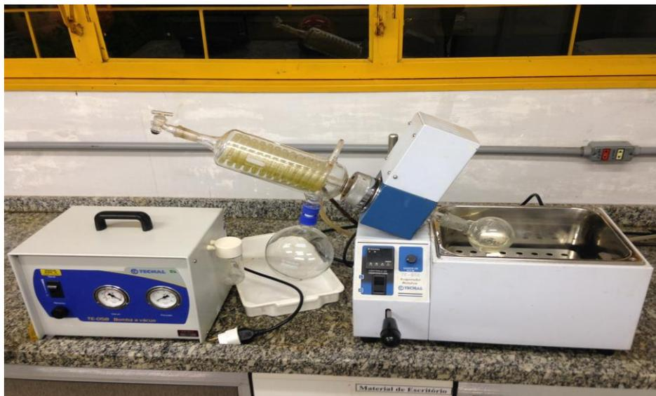
**Figura 17 – Processo de Rotoevaporação.**
