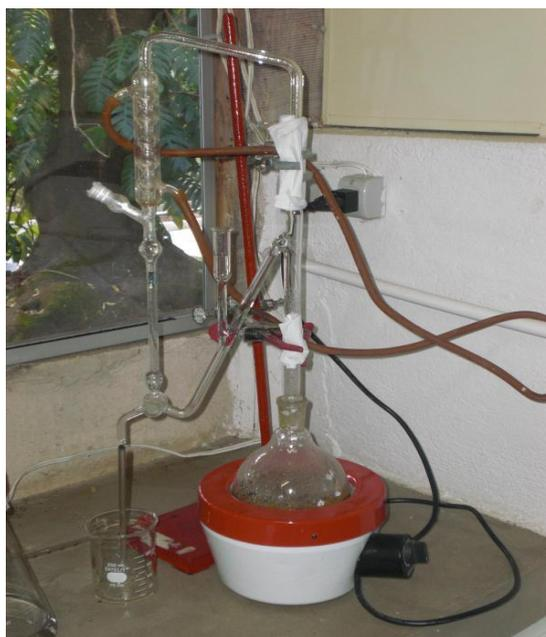
**Figura 14 – Processo de Hidrodestilação (AZAMBUJA, 2013).**
