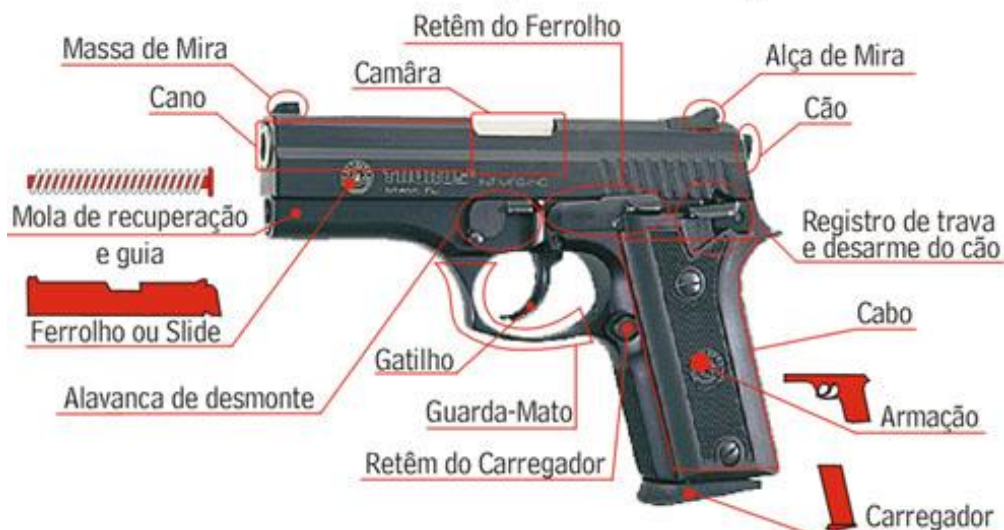
Figura 6 – Armas de fogo e nomenclatura de seus componentes (SCOPEL, 2015).
