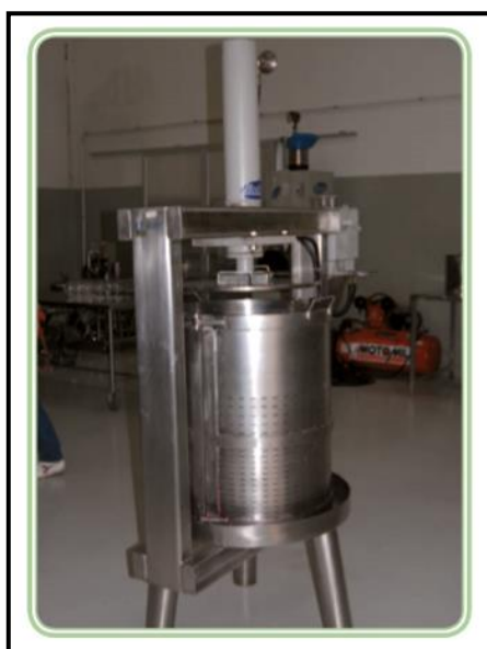
Figura 53 - Prensa Vertical pneumática (In: LIMA, FILHO, 2011, p. 44)
