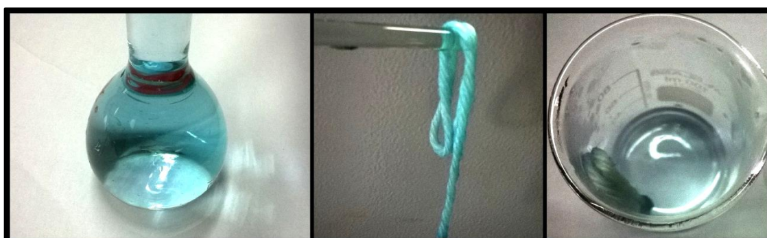
Figura 75 – A esquerda se tem o balão com Azul de Indigotina a 0,01%, ao meio se tem a lã colorida pelo corante e a direita se tem o extrato final obtido na cor azul comprovando a eficiência do método.
