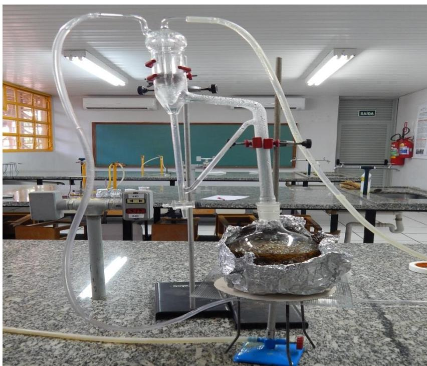
**Figura 7 - Aparelho de Hidrodestilação Clevenger**
