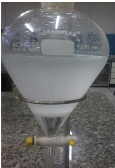
**Figura 8 - Emulsão formada após a adição de diclorometano**
