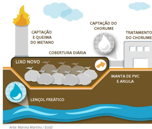
**Figura 11 – Esquema de como deve ser um aterro controlado (In: RUMO SUSTENTÁVEL, 2014).**
