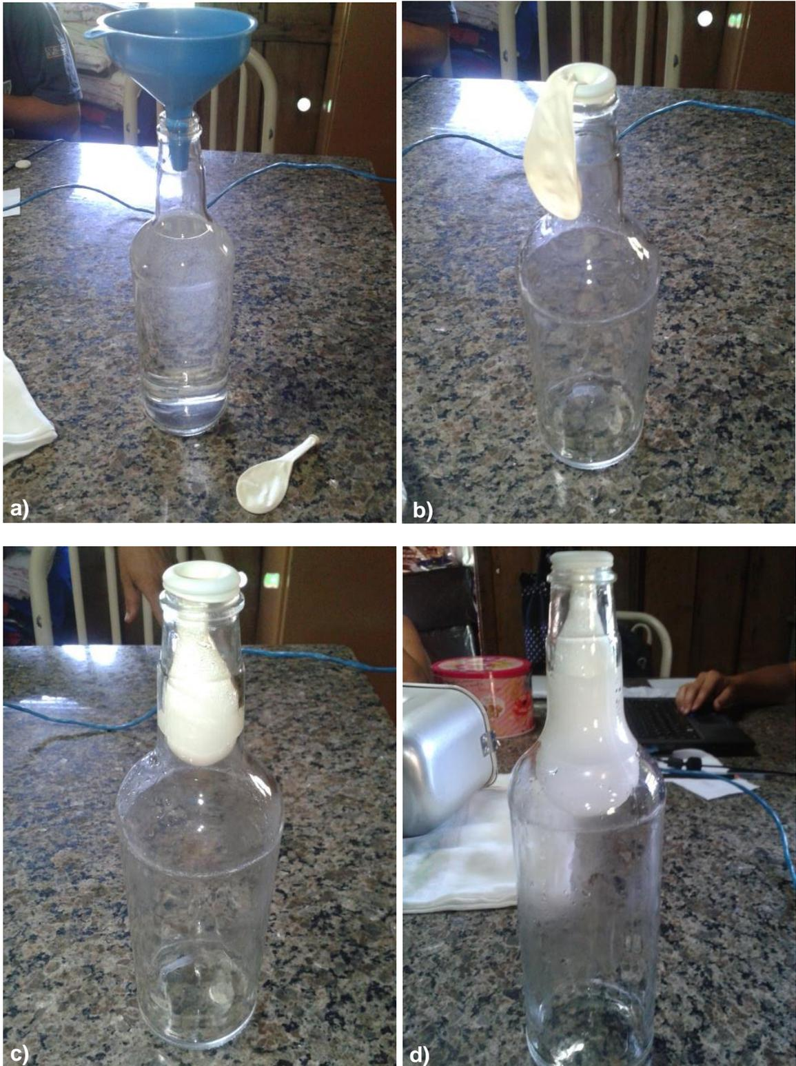
**Figura 28:** a) materiais utilizados; b) bexiga colocada na boca da garrafa após esvaziar a água; c) bexiga começando a encher; d) bexiga cheia dentro da garrafa.
