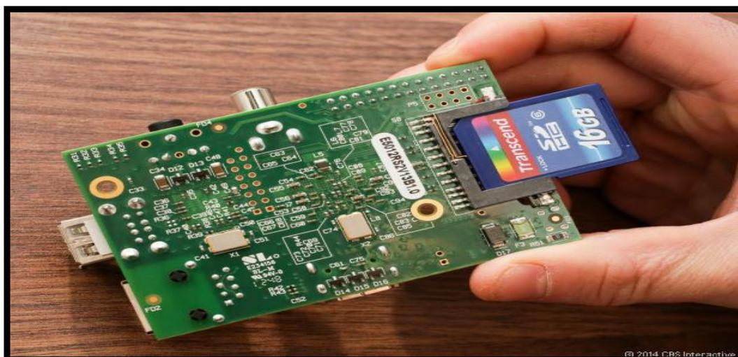
**Figura 6 - Parte de trás da placa *Raspberry Pi* (In: GEEK MUNDO)**
