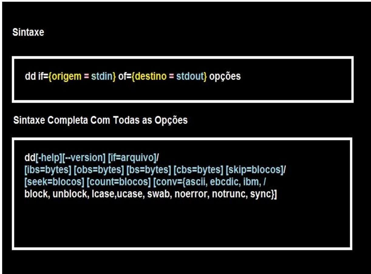
**Figura 13: Sintaxe para a utilização da ferramenta DD**
