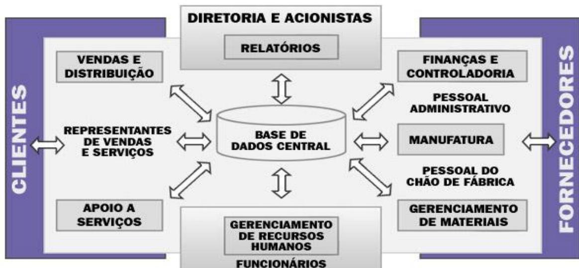
Figura 2: Estrutura típica de um sistema ERP
